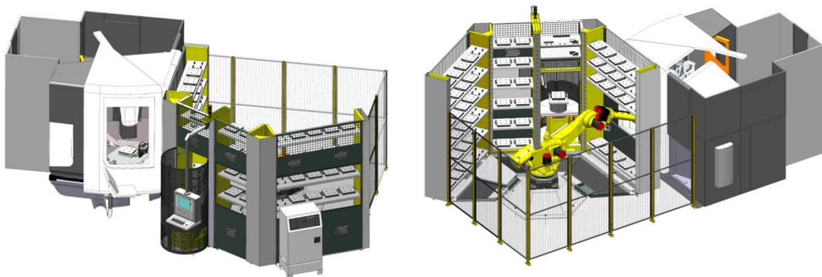
Die Maschine wird bei Landes während Tageszeit eingestellt und für die Bearbeitungen vorbereitet. Nach erfolgreiche Erstmusterprüfung kann die Maschine unbemannt weiter
